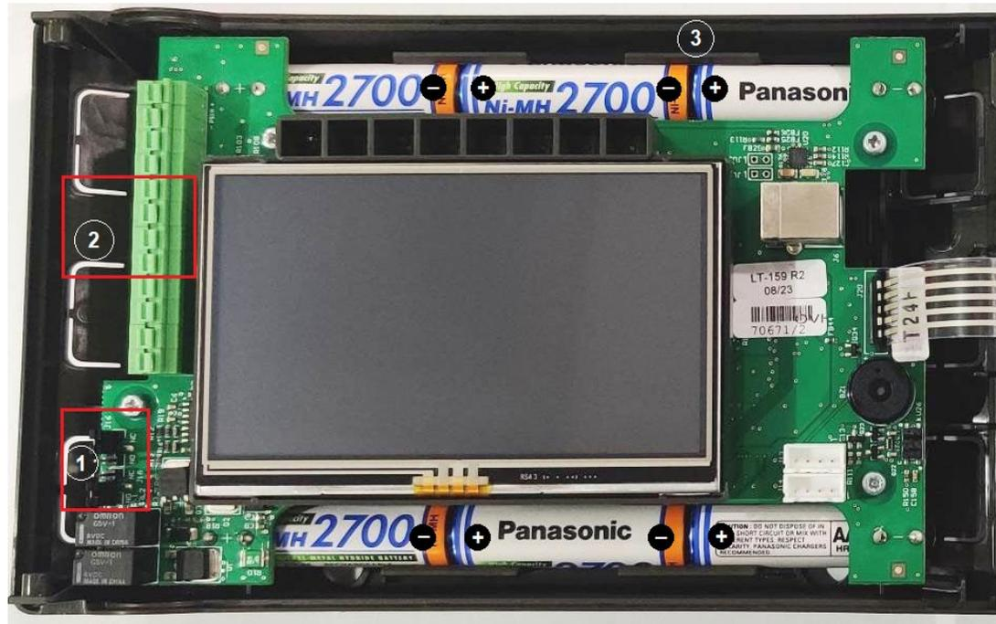
Abb. 17: Übersicht über Aufbau und Anschlüsse des LT-159
