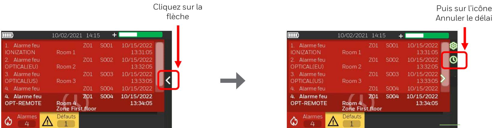
5. L'option annuler le délai est maintenant activée sur l'écran principal, ce qui permet à l'utilisateur d'activer les sorties configurées avec un délai dans la matrice cause & effet E/S avant la fin du compte à rebours.
