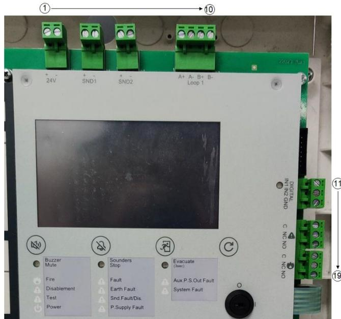
Abb. 16: Anschlussreihenfolge der Hauptplatine
