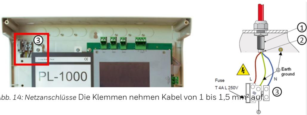
Abb. 14: Netzanschlüsse Die Klemmen nehmen Kabel von 1 bis 1,5 mm<sup>2</sup> auf.
