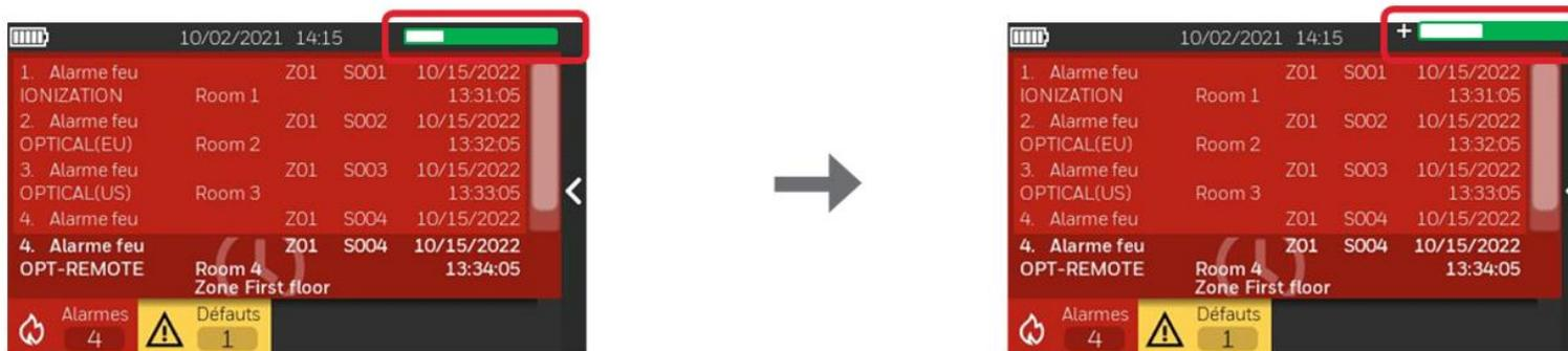
4. Lorsqu'un délai est activé, une barre de progression temporelle apparaît sur l'écran principal pour montrer l'avancée du délai. Si une autre zone réglée pour fonctionner avec un délai passe en état d'alarme, un signe + apparaît à côté de la barre de délai, indiquant qu'un autre compte à rebours a été lancé.
