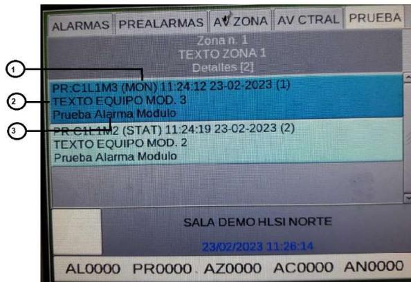
Al presionar la tecla enter
