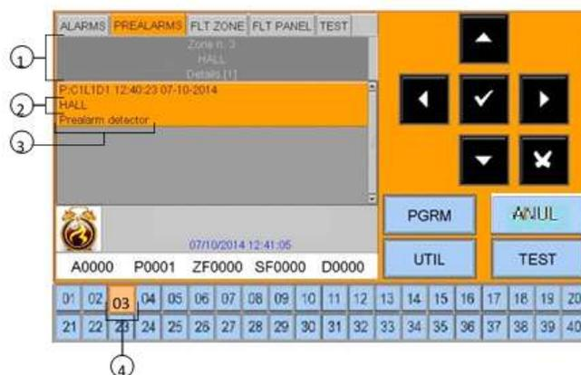
Use las flechas por la pantalla y seleccione la zona que se quiere visualizar. Una vez seleccionada pulse la tecla  y tendrá acceso al listado de Puntos en Prealarma de la zona seleccionada; Usando las flechas se visualizará los puntos en prealarma.
