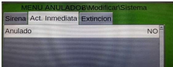
Para cambiar este parámetro en esta pestaña, pulse la tecla ENTER y utilice las teclas de flechas para seleccionar **SÍ** o **NO** y a continuación, pulse la tecla ENTER para confirmar la entrada.
